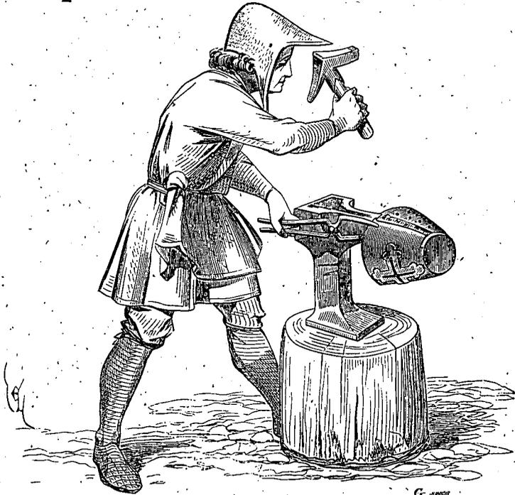
rales se terminaient en cône horizontal (bigornes), afin de permettre d'arrondir les pièces de fer au marteau.
